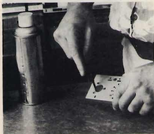
figura 6 Con una lama ben affilata si asporta l'acetato eccedente in corrispondenza dei fori.
